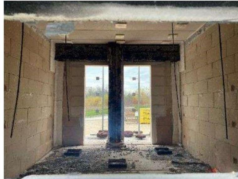
**Fin de l'essai :** entre 1h30 et 2h après le départ de feu, l'ensemble des bûchers du foyer primaire a été consommé, la température décroît et aucun auto-entretien de la structure bois n'est observé.
